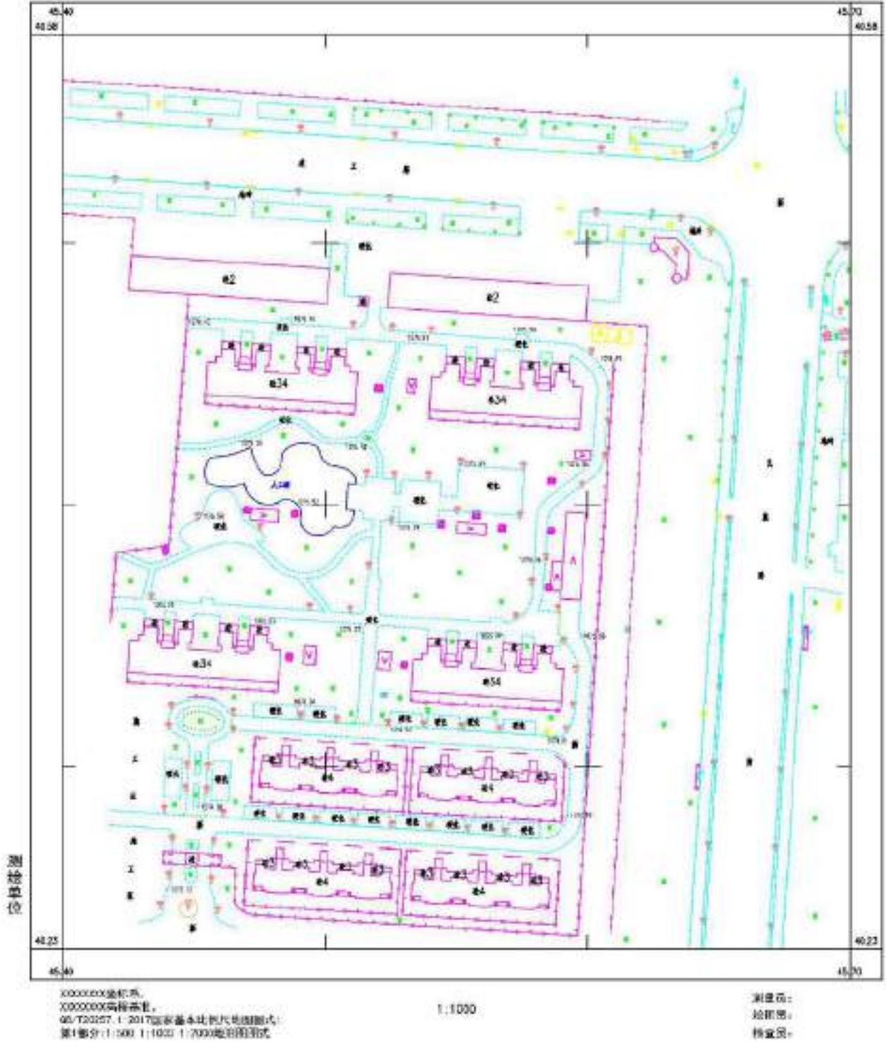
图 F.3 竣工测绘地形图样示
